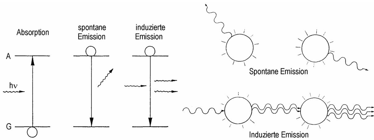
Schematische Darstellung der Absorption, spontanen Emission und induzierten Emission. Bei der induzierten Emission haben induziertes und emittiertes Photon gleiche Phase und gleiche Richtung.
